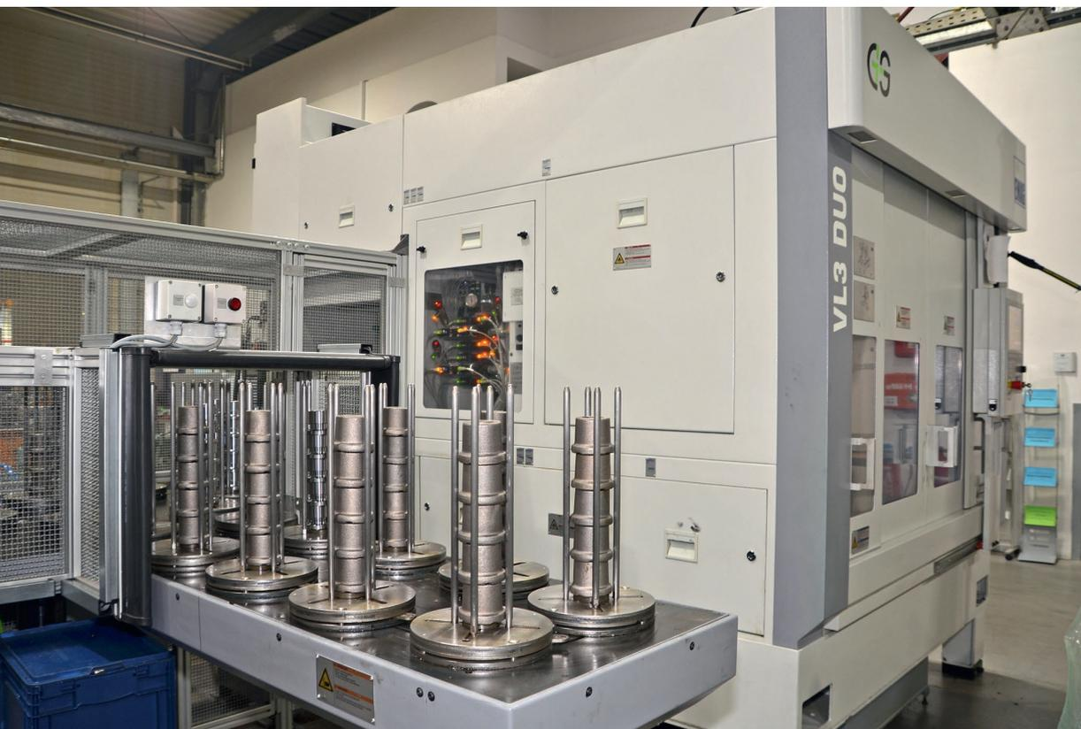
1 Seit die leistungsstarken Drehmaschinen beim Lohnfertiger Kronawitter mit Werkzeugen von ZCC Cutting Tools laufen, sind die Prozesse stabil, und die Stückzeit sank im Durchschnitt um 30 Prozent. Hier eine Emag VL 3 Duo beim Fertigen von Getriebe-Komponenten für Kleinlastler © Hanser
