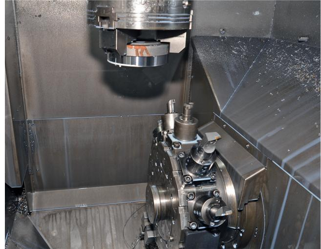
**4** Auch hier beim Drehfräsen von Hohlrädern auf einer der beiden Emag VL 6 sichern die Drehplatten von ZCC Cutting Tools mit ihrem 'scharfen Schnitt' einen stabilen Prozess © Hanser
